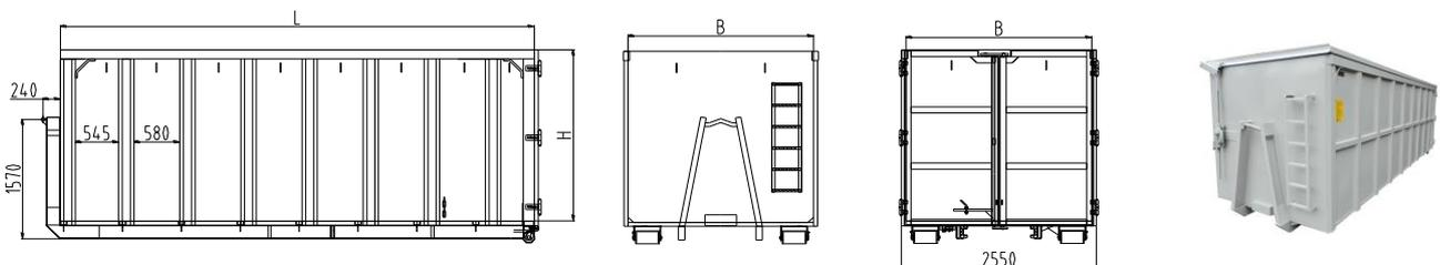
**„Typ L“ ( Nutzlast ca. 8000 kg ) Boden, Seiten und Türen 3 mm Blech und einem seitlichen Spantenabstand von ca. 795 mm bzw. ca. 830 mm, aus Gütestahl S 235 JRG2. Sonst wie vorstehend beschrieben.**
